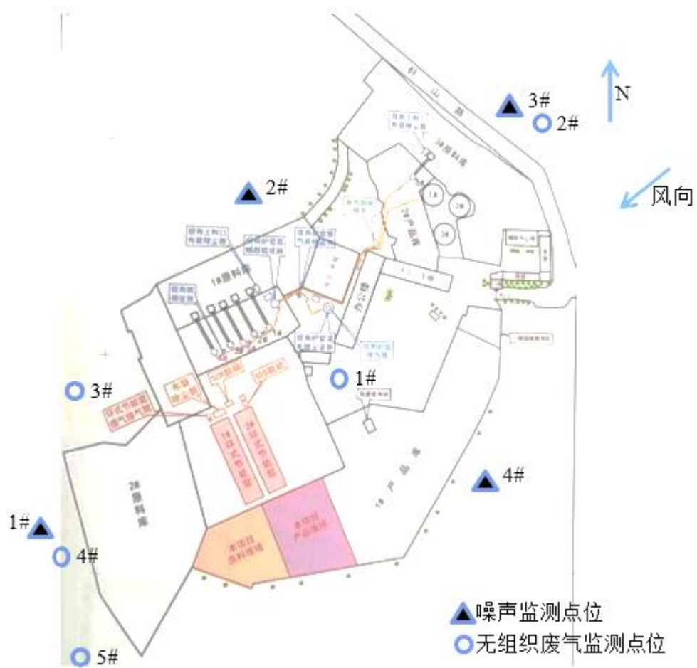
图6.2 厂界无组织颗粒物与噪声监测点位示意图
